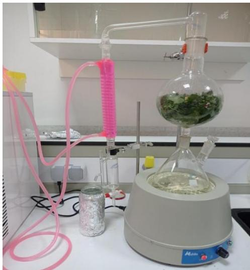
**Figure 12** : Extraction par hydrodistillation par entraînement à la vapeur.
